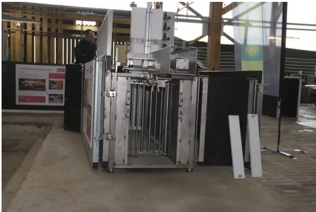
Photo 41. Afin de faciliter les essais à l'auge, du matériel spécifique va faciliter les prises de mesures. A l'entrée à l'aire d'alimentation, la pesée quotidienne se fera via une bascule qui va peser chaque porc à l'entrée, identifié par une puce électronique de type RFID fixée à l'oreille. Certains systèmes de pesée en continue sont plus simples mais basés sur le même système.
